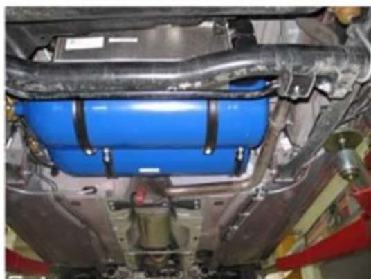
Obr. č. 3: Umístění palivových nádrží CNG v podvozku
