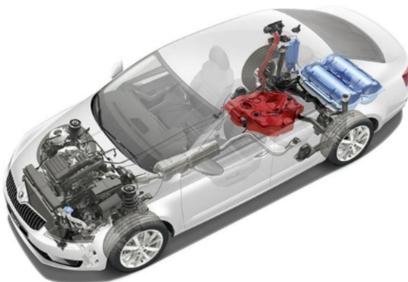
Obr. č. 2: Pohonná soustava vozidla na CNG (Škoda Octavia G-TEC)
