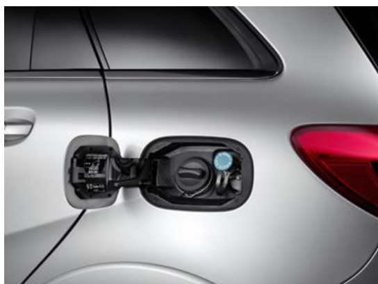
Obr. č. 5: Způsob plnění CNG do vozidla (modrý kryt je na CNG, černý na benzin)
