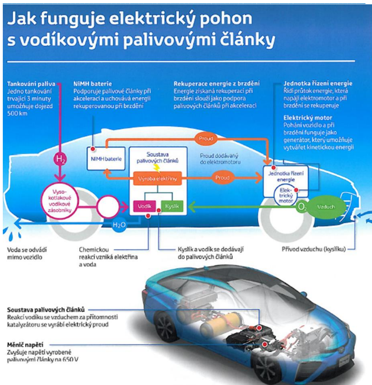
Obr. č. 28: Princip fungování vozidla na vodíkový pohon
