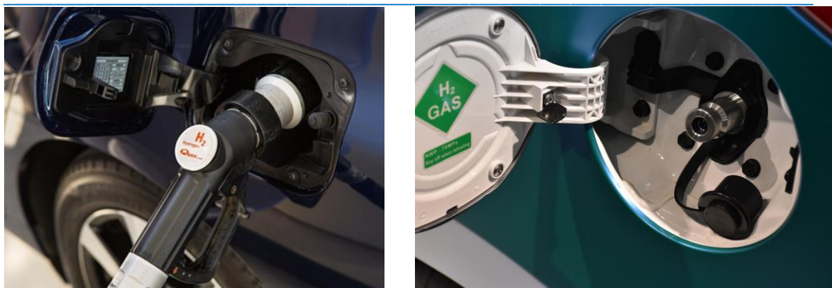
Obr. č. 29: Plnicí hrdlo
