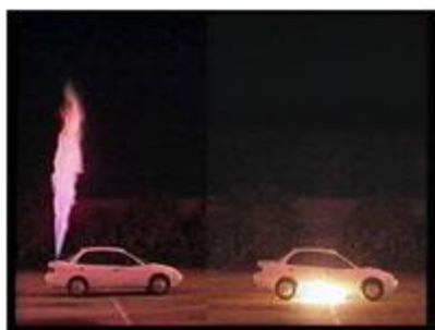
Obrázek 4 Test vznícení vodík versus benzin
